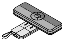
Positionner la télécommande à copier sous la nouvelle télécommande comme l'illustre la figure, puis effectuer une transmission avec la touche que l'on veut cloner.
